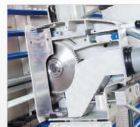
▶ Große Öffnung für Sägeblattwechsel
