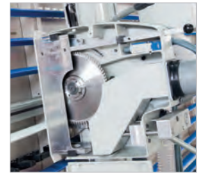
▶ Große Öffnung für Sägeblattwechsel
