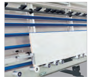
▶ Einfacher und schneller Zuschnitt auch kleiner Teile. Untere Plattenauflage mit Maßanzeige
