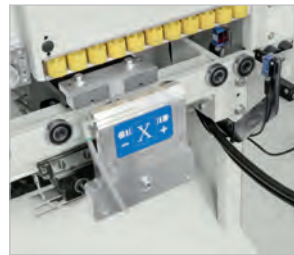
Pneumatische Spannzange für Werkstückpositionierung
