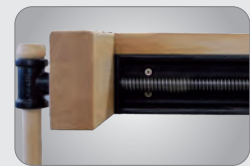
Massive Linearführung an der Hinterzange
