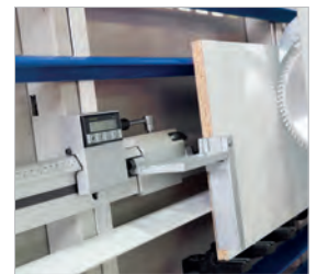
▶ Digitale Maßanzeige zur Längeneinstellung beim Vertikalschnitt
