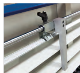
▶ Lineal zur Längeneinstellung beim Vertikalschnitt
